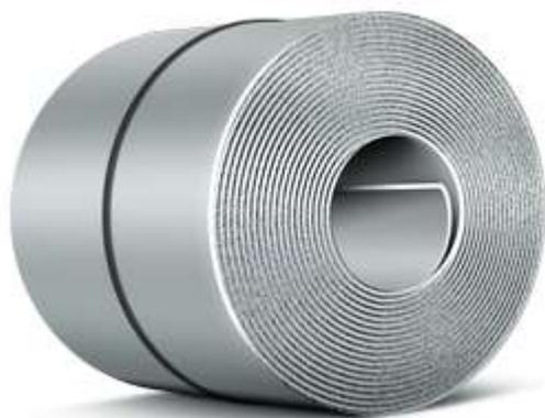
Холоднокатаную рулонную сталь получают в результате пластической деформации горячекатаных заготовок на станках холодной прокатки. По сравнению с горячекатаными рулонами такая обработка обеспечивает более точные допуски на размеры, лучшее качество поверхности и улучшенные механические характеристики. Кроме того, холодная прокатка позволяет получить более тонкие рулоны.
