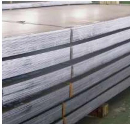
Горячекатаные стальные листы представляют собой плоский прямоугольный металлопрокат, полученный в результате горячей прокатки стальной заготовки. Для его изготовления используется сталь различных марок: углеродистая, низколегированная и легированная.
